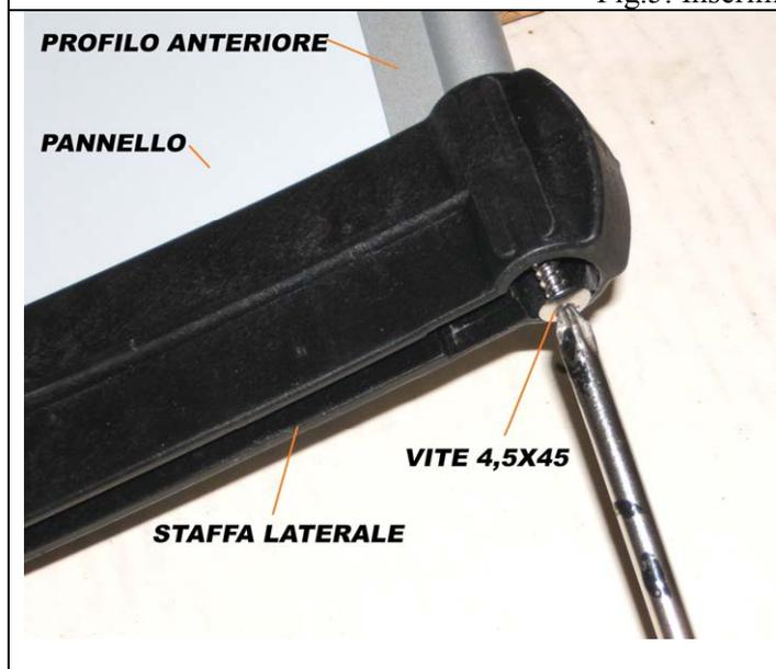
Fig.6: Fissaggio staffa laterale sul profilo anteriore
