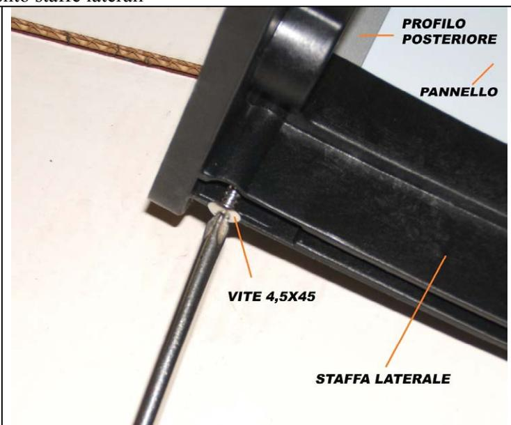
Fig.7: Fissaggio staffa laterale sul profilo posteriore
